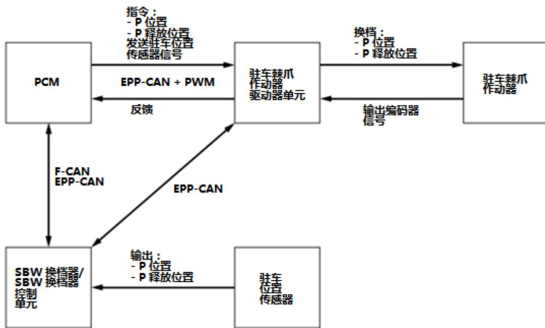
换档控制系统包括驻车控制、自动切换到 P 位置/模式控制、空档位置/模式保持模式控制和误操作防止控制。
